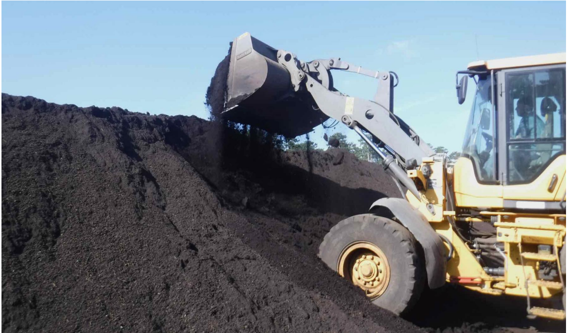
Fotos 3 und 4: Probenahmeschnitt Lader
